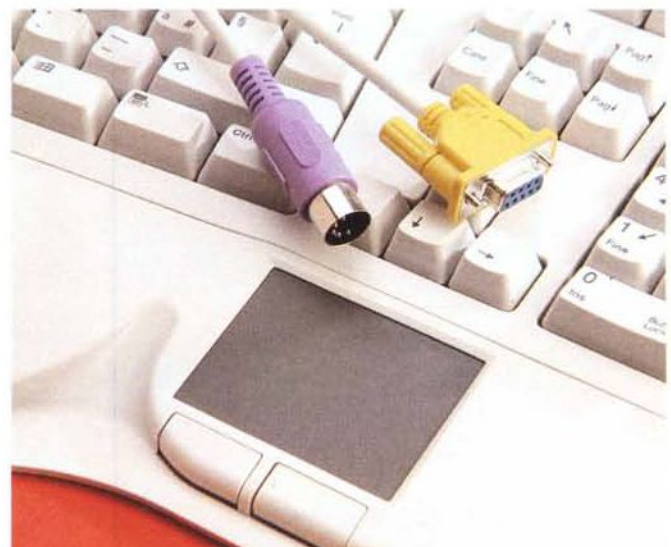
A sinistra: la tastiera dispone di un connettore per il collegamento di un mouse esterno; la commutazione fra mouse e trackpad integrata avviene mediante un interruttore posto sul fondo. A destra: particolare del trackpad e dell'estremità del cordone di collegamento della tastiera al computer.
